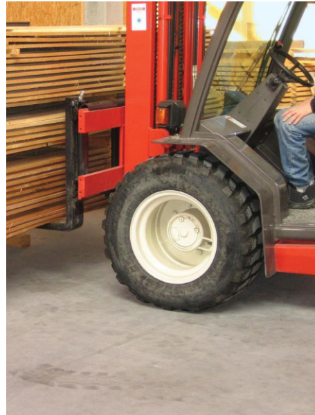
Bild 5. Gabelstaplerbetrieb Kategorie G3 Fig. 5. Operation of fork lift category G3
